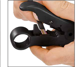
Ściąganie izolacji z kabla taśmowego.
