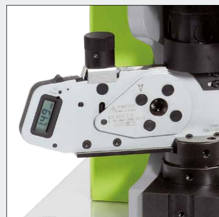
Głowica zagniatająca 4-punktowego z wyświetlaczem cyfrowym.
