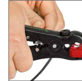
Cięcie kabla koncentrycznego.
